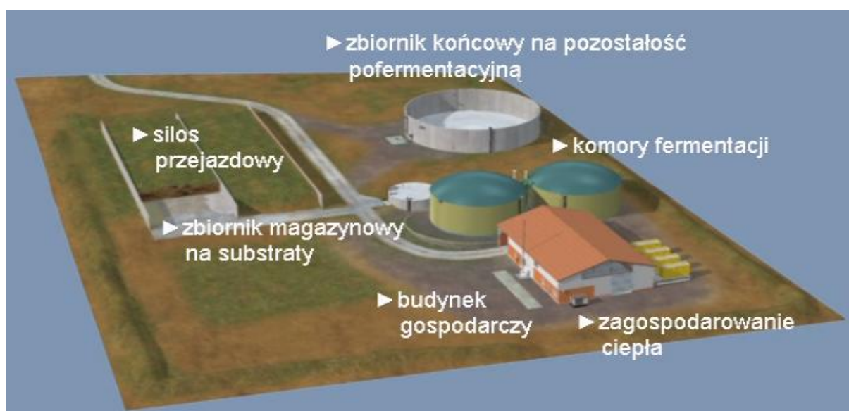
Ilustracja 1 Biogazownia rolnicza firmy EnerCess GmbH
